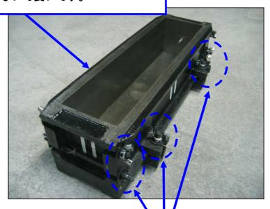
・固定ビスの締め付けは、指で締まる程度の仮組で結構です。
